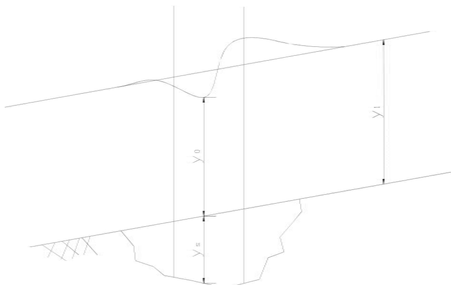
Figura A.2. Definizione delle variabili adottate nelle formule per il calcolo dell'erosione generalizzata.
